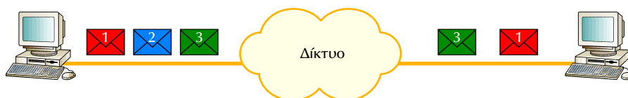
Σχήμα 1-7 Στην υπηρεσία χωρίς σύνδεση τα πακέτα μεταφέρονται με τυχαία σειρά και δεν υπάρχει εγγύηση ότι θα παραληφθούν χωρίς λάθη
