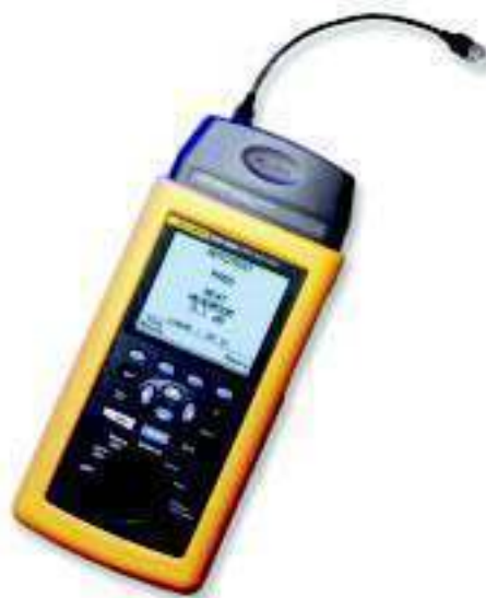
Εικόνα 5-12 Το όργανο μέτρησης TDR
