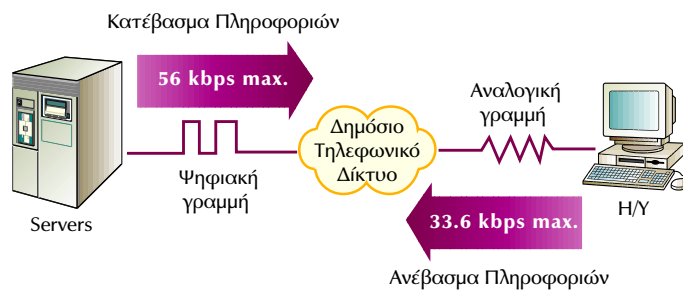
Σχήμα 5-3 Σύνδεση υπολογιστών με V.90 modem, σε Παροχέα Υπηρεσιών Διαδικτύου, κάνοντας χρήση του δημόσιου τηλεφωνικού δικτύου (α) Τοπολογία διασύνδεσης (β) Μετατροπές A/D ή D/A που γίνονται στο σήμα εάν χρησιμοποιούνται modem V.90 ή V.34 (γ) Απεικόνιση της ασυμμετρικής σύνδεσης στην περίπτωση χρησιμοποίησης V.90 modems
