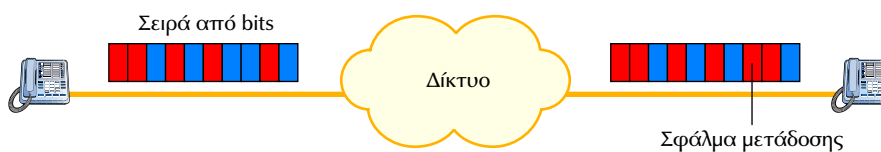
Σχήμα 1-4 Στην υπηρεσία σύγχρονης επικοινωνίας κάθε bit καθυστερεί το ίδιο
