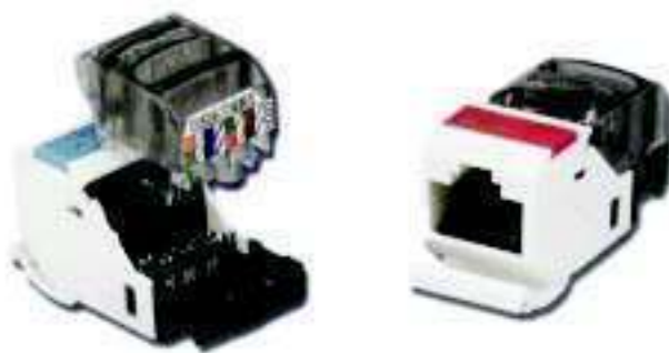
Εικόνα 5-5 Οι επαφές τερματισμού του καλωδίου στον υποδοχέα. Ο τερματισμός γίνεται κλείνοντας το πλαστικό καπάκι στην πίσω πλευρά του υποδοχέα
