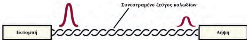
Εικόνα 2.4.1.θ: Εξασθένηση (Attenuation, Insertion Loss).
