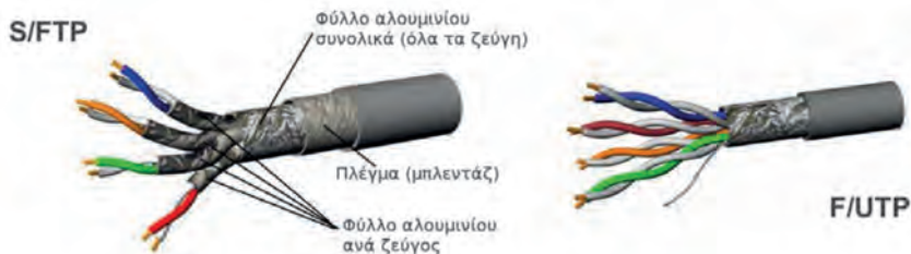
Εικόνα 2.4.1.η: Θωρακισμένα καλώδια συνεστραμμένων ζευγών.
